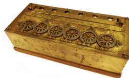
Zwölfspeziere Rechenmaschine von Blaise Pascal, 1642, Kopie des Originals im CNAM, Paris, FDM 9615, © Arithmeum
